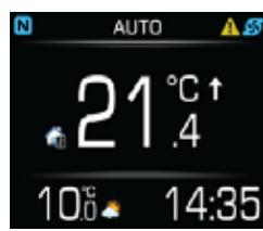
Vstopite v meni parametri s pritiskom na tipko . S pritiski na tipko ali poiščite parameter **način delovanja ogrevalnega kroga**.
