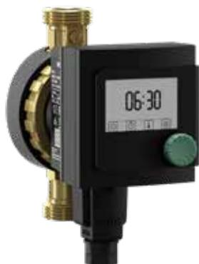
**Descrizione** Circolatore ad alta efficienza per acqua calda sanitaria, attacco filettato, potenza 5,0 [W], flusso 0,4 [m<sup>3</sup>/h], pressione 0,1 [bar]
