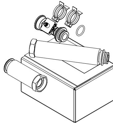
**Beschreibung** Durchflusssensor-Kit für WR KSM 2, Spannungsfühler
