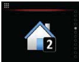
Selezionare il menu del circuito di riscaldamento premendo **OK**
